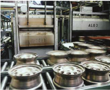
Aluminium- industrie: Aushärtungs- ofen für Felgen
